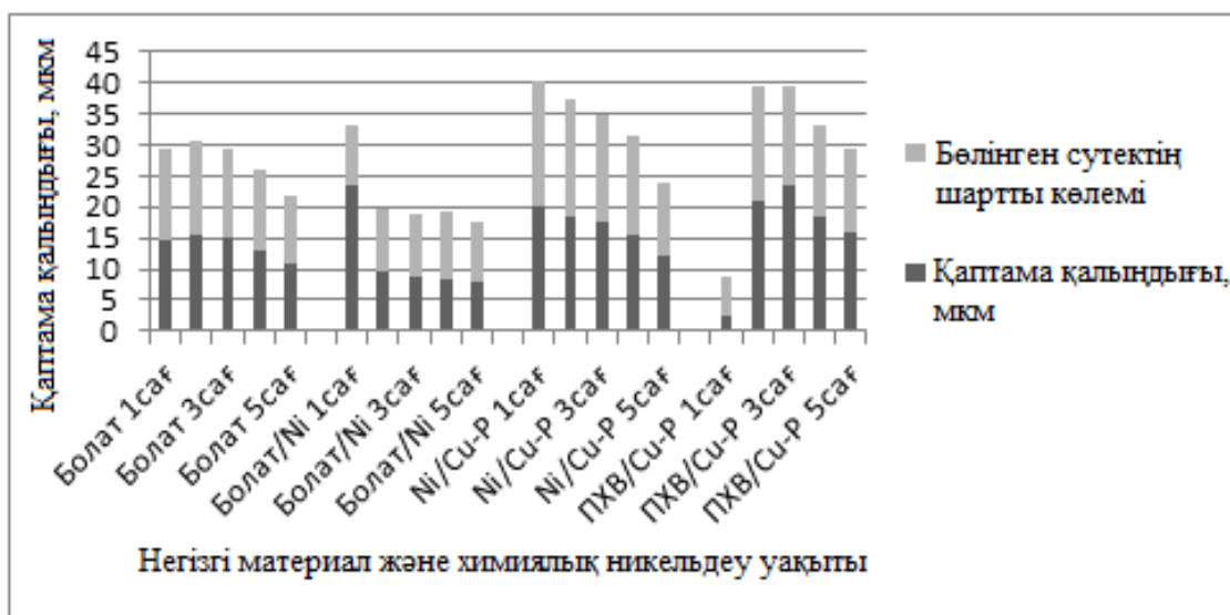
Сурет 3.32 - Әртүрлі негіздерде сілтілі электролиттерден химиялық никельдеу барысында металл қаптаманың түзілу жылдамдығы мен сутектің бөлінуі арасындағы қатынас
